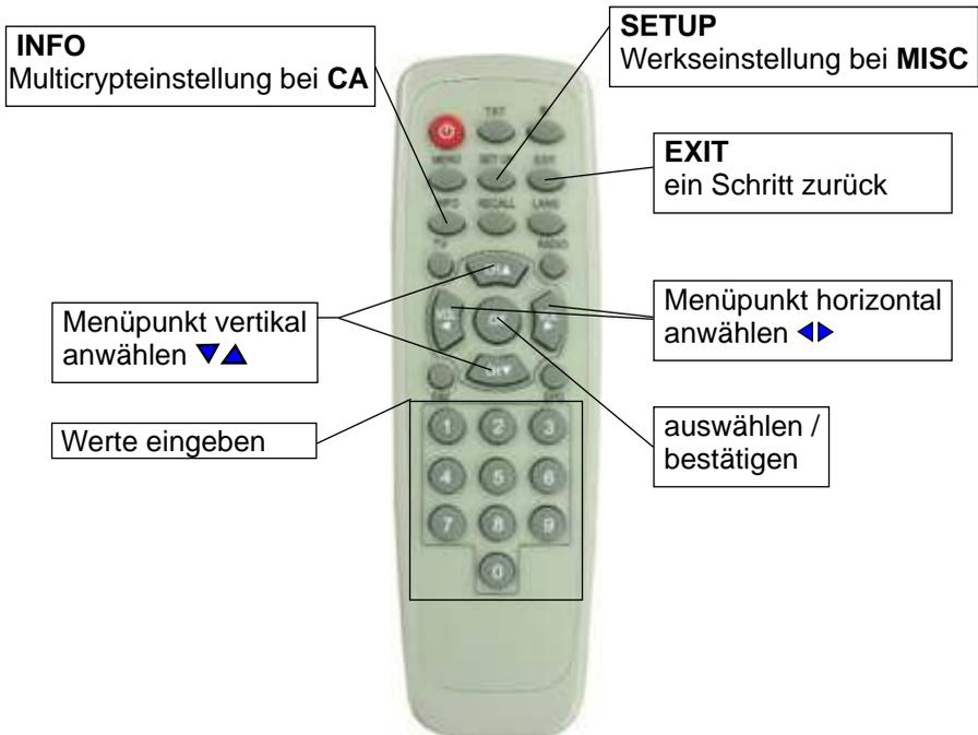
Aufgrund der IR-Übertragung muss die Fernbedienung bei der Programmierung auf die IR-Schnittstelle im Grundgerät gerichtet werden.
